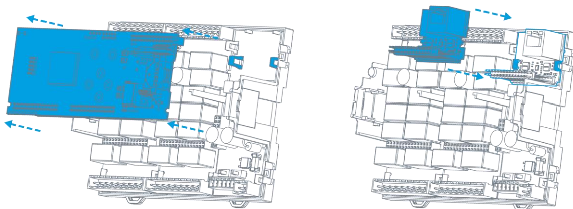
Рис. 27 - Снятие процессорной платы и установка платы сетевого модуля
